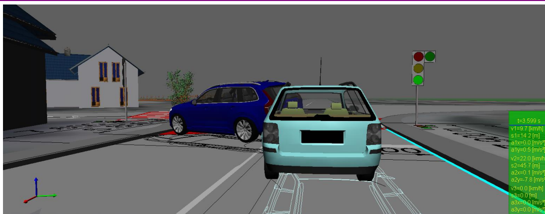
Obr. 21 Situácia v čase tesne pred stretom vozidiel Volvo XC90 a VW Passat, pohľad zo smeru jazdy vozidla VW Passat – zelený signál signálnej skupiny D3
