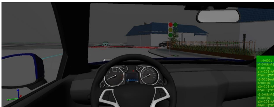
Obr. 14 Situácia v čase cca 2,60 s pred zrážkou vozidiel Volvo XC90 a Honda CR-V z pohľadu vodiča vozidla Volvo XC90 – červený signál signálnej skupiny D1
