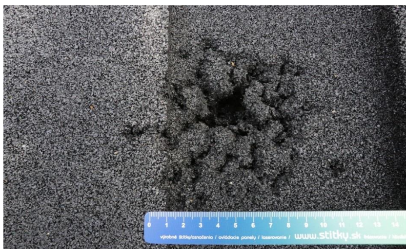
Obr. 11 Zadná strana balistickej gumy, kde je zreteľnejší rozptyl vedenej strel'by na dopadové miesto testovanej gumy
