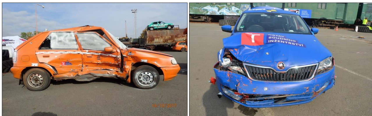
Obr. 2 Deformace vozidel [ÚSI VUT v Brně]
