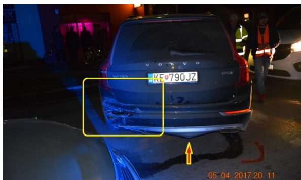
Obr. 8 Poškodenia vozidla Volvo XC90 po strete s vozidlom VW Passat
