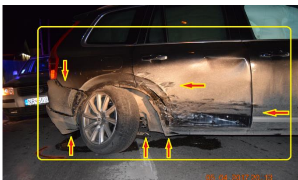
Obr. 4 Poškodenia vozidla Volvo XC90 po strete s vozidlom Honda CR-V
