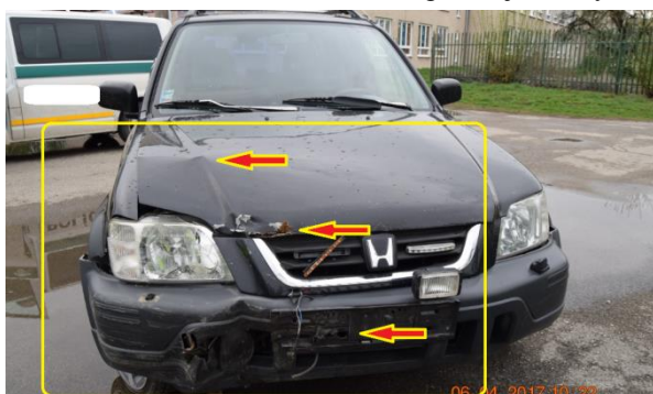
Obr. 2 Poškodenia vozidla Honda CR-V
