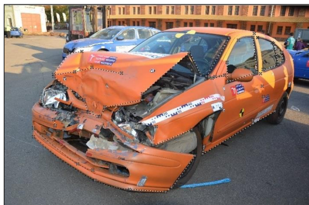
Obr. 5 a Obr. 6 3D model vozidla Renault v programu PhotoModeler (vlevo), označení společných bodů jednotlivých snímků (vpravo)
