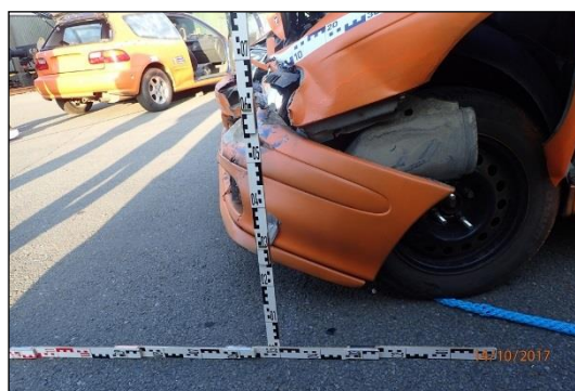
Obr. 14 a Obr. 15 Zaměření hloubky deformace přídě vozidla Renault z bočního pohledu
