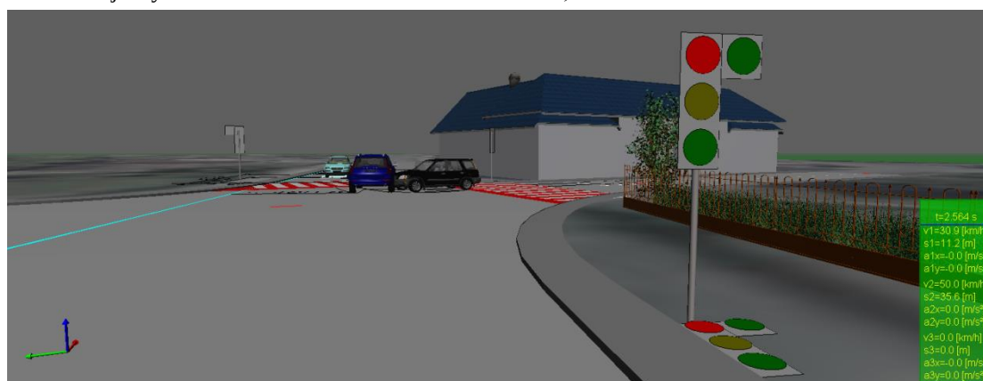
Obr. 17 Situácia v čase tesne pred zrážkou vozidiel Volvo XC90 a Honda CR-V, pohľad zo smeru jazdy vozidla Volvo XC90 – červený signál signálnej skupiny D1
