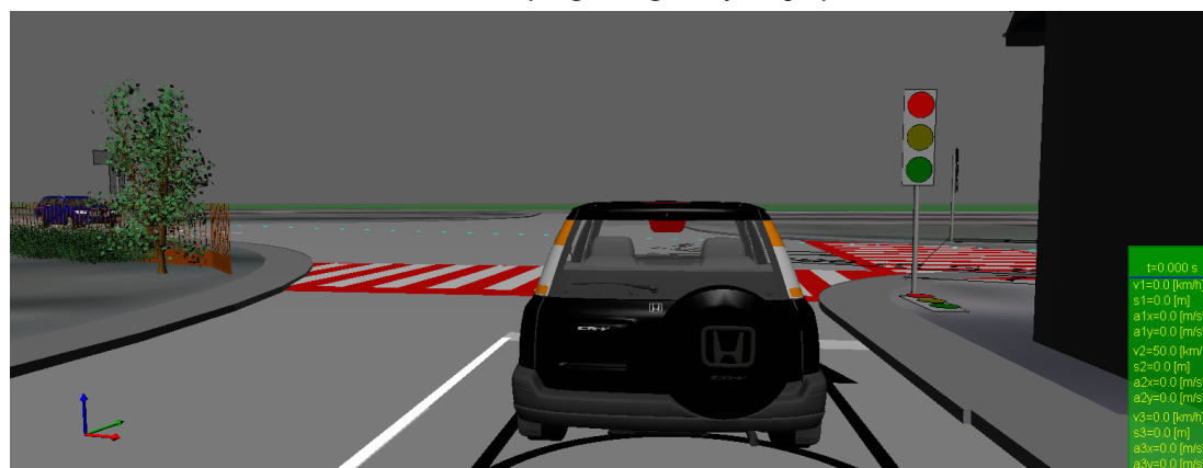
Obr. 16 Situácia v čase cca 2,60 s pred zrážkou vozidiel Volvo XC90 a Honda CR-V, pohľad zo smeru jazdy vozidla Honda CR-V – červený signál signálnej skupiny D4
