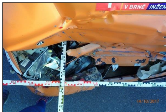
Obr. 12 a Obr. 13 Zaměření hloubky deformace přídě vozidla Renault
