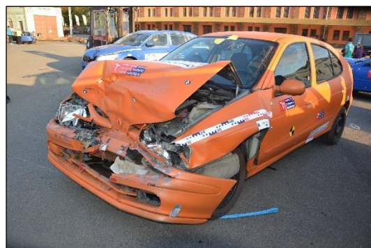
Obr. 2 a Obr. 3 Vozidlo Renault po nárazové zkoušce
