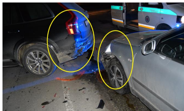
Obr. 9 Poškodenia vozidla Volvo XC90 po strete s vozidlom VW Passat
