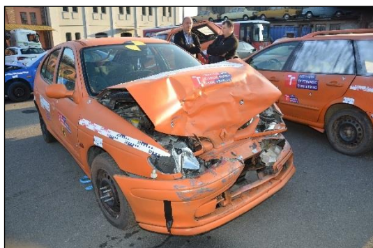
Obr. 2 a Obr. 3 Vozidlo Renault po nárazové zkoušce
