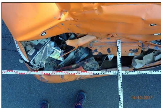
Obr. 12 a Obr. 13 Zaměření hloubky deformace přídě vozidla Renault
