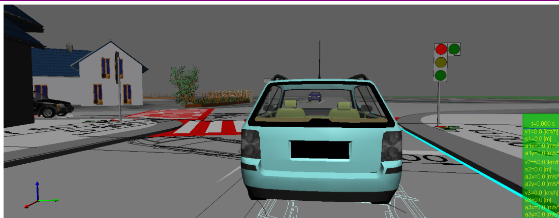
Obr. 15 Situácia v čase cca 2,60 s pred zrážkou vozidiel Volvo XC90 a Honda CR-V, pohľad zo smeru jazdy vozidla VW Passat – červený signál signálnej skupiny D3
