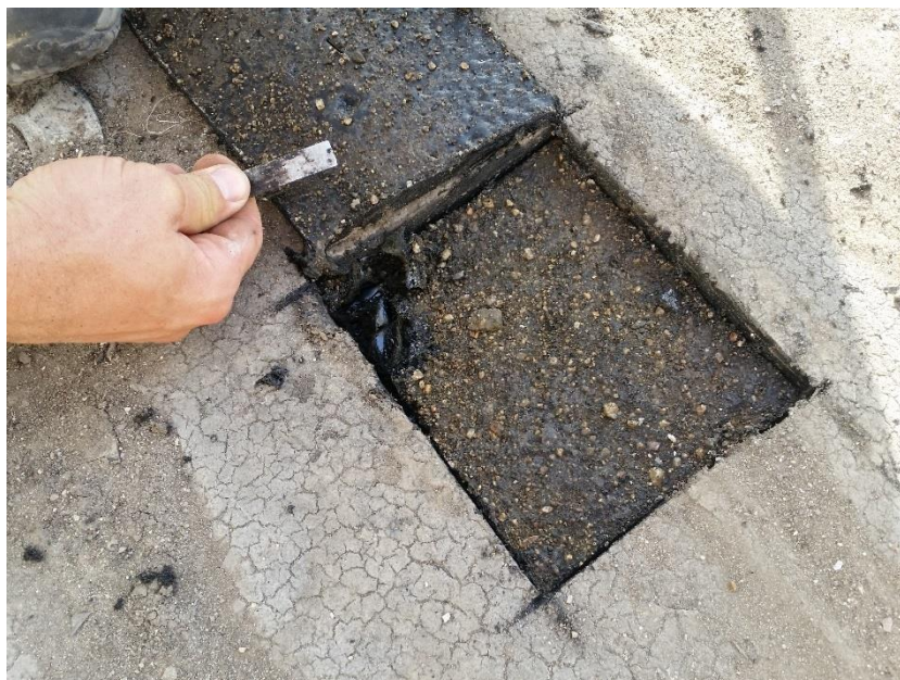
Obr. 3 Ukázka z odebrání sondy [7]
