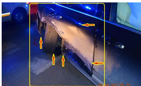
Obr. 5 Poškodenia vozidla Volvo XC90 po strete s vozidlom Honda CR-V
