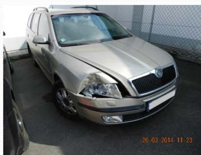
Obr. 5 Poškození vozidel při střetu se stromem s poškozením bočním části přídě s malou střetovou rychlostí [7]
