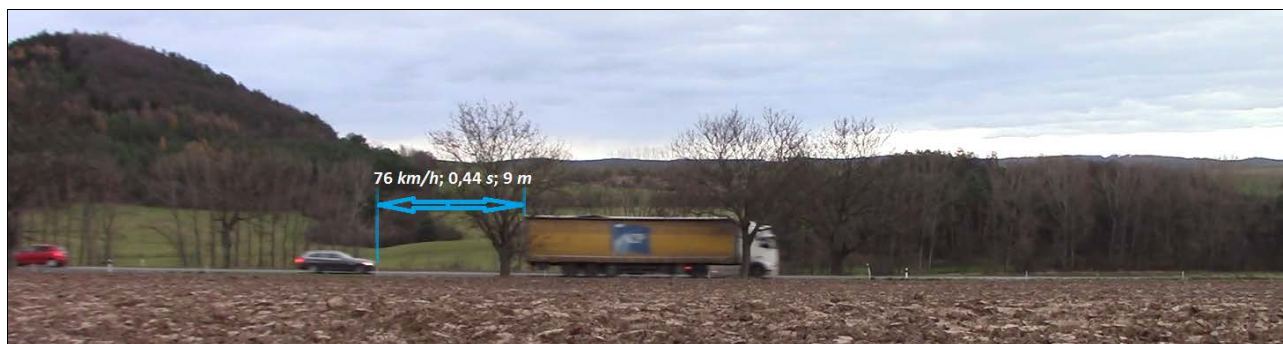
Obr. 4 Rychlost 76 km/h, odstup 0,44 s, resp. 9 m
