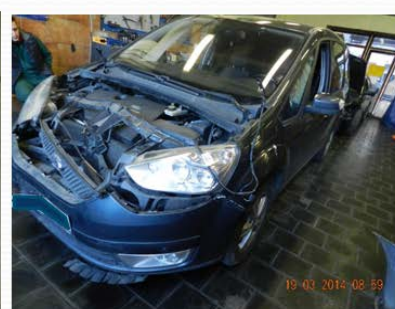
Obr. 7 Poškození vozidel při střetu se stromem s poškozením střední části přídě s malou střetovou [7]
