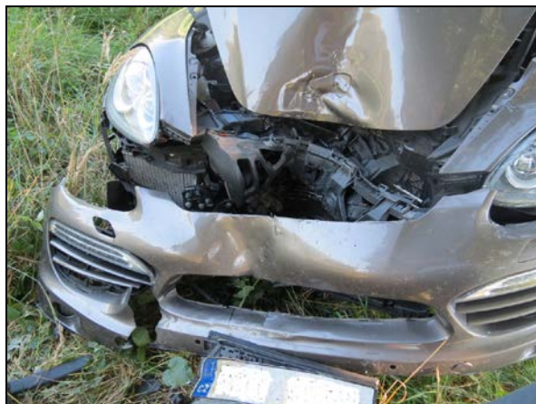
Obr. 2 a 3 Poškození přední části vozidla Porsche [5]
