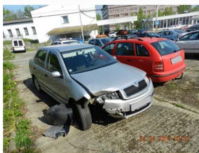
Obr. 5 Poškození vozidel při střetu se stromem s poškozením bočním části přídě s malou střetovou rychlostí [7]
