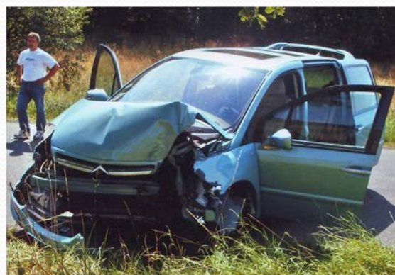
Obr. 6 Poškození vozidel při střetu se stromem s poškozením boční části přídě s velkou střetovou [7]
