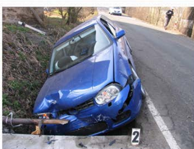
Obr. 9 Poškození vozidel při střetu s propustkem s poškozením přední části vozidla [7]
