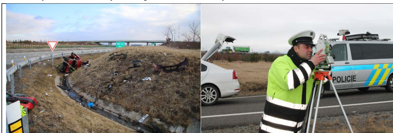
Obr. 5 a, b Konečná poloha vozidla a zaměření místa totální stanicí
