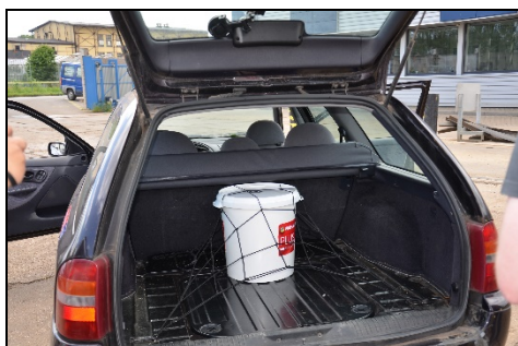
Obr. 11 a 12 Vlevo – umístění barvy a její zajištění sítíkou při znaleckém experimentu, vpravo – nárazová zkouška znaleckého experimentu provedené dne 16.06.2016 [5]
