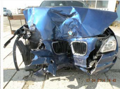
Obr. 8 Poškození vozidel při střetu se stromem s poškozením střední části přídě s velkou střetovou [7]
