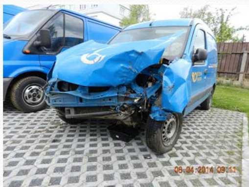
Obr. 6 Poškození vozidel při střetu se stromem s poškozením boční části přídě s velkou střetovou [7]
