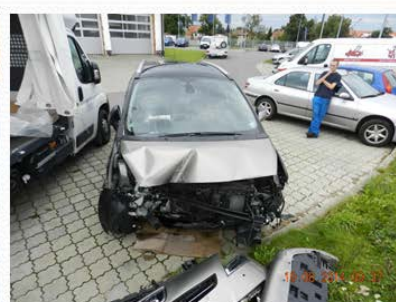
Obr. 9 Poškození vozidel při střetu s propustkem s poškozením přední části vozidla [7]
