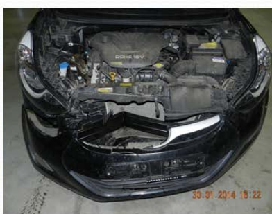
Obr. 7 Poškození vozidel při střetu se stromem s poškozením střední části přídě s malou střetovou [7]
