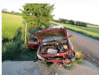
Obr. 9 Poškození vozidel při střetu s propustkem s poškozením přední části vozidla [7]
