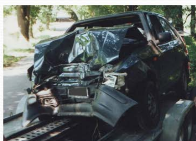
Obr. 8 Poškození vozidel při střetu se stromem s poškozením střední části přídě s velkou střetovou [7]
