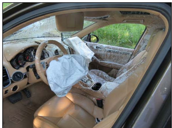
Obr. 4 a 5 Poškození interiéru vozidla Porsche [5]
