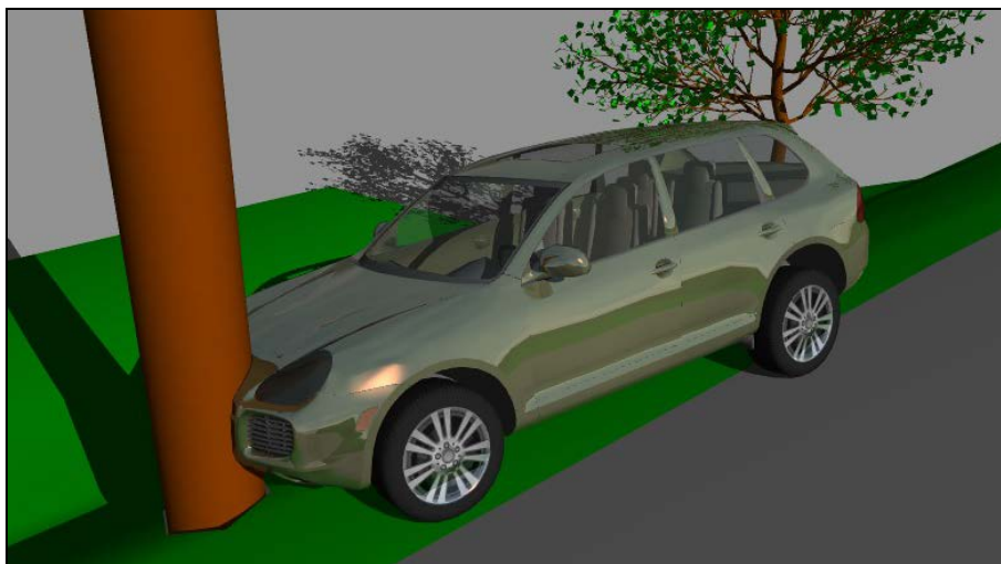
Obr. 6 Možná střetová konfigurace vozidla Porsche a stromu v místě DN [5]
