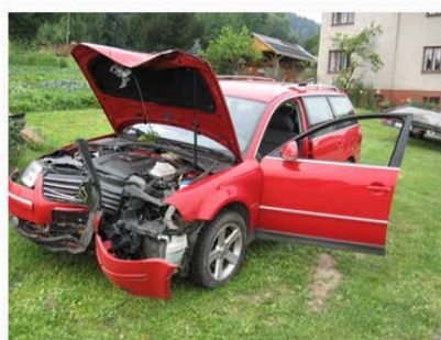
Obr. 7 Poškození vozidel při střetu se stromem s poškozením střední části přídě s malou střetovou [7]
