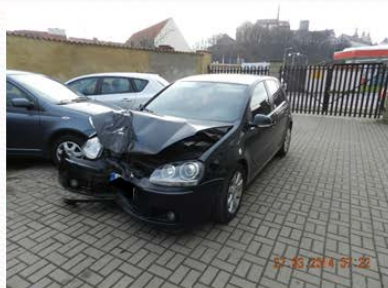
Obr. 8 Poškození vozidel při střetu se stromem s poškozením střední části přídě s velkou střetovou [7]
