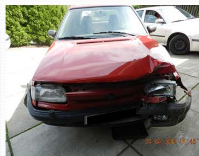
Obr. 5 Poškození vozidel při střetu se stromem s poškozením bočním části přídě s malou střetovou rychlostí [7]
