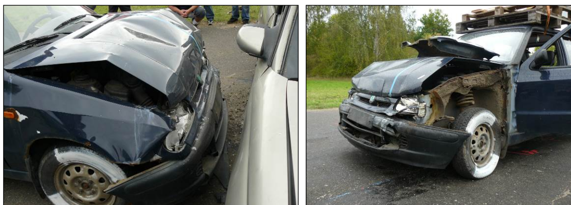
Obr. 22 a 23 Celková energie před střetem 43 kJ, Celková deformační energie: 15 kJ. Pokud uvažujeme EES vozidla Škoda Felicia = 18 km/h, pak EES vozidla Opel Omega kombi = 8 km/h
