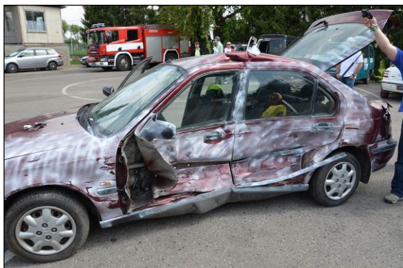
Obr. 14 a 15 Celková energie před střetem 108 kJ, Celková deformační energie: 43 kJ EES vozidla Honda = 26 km/h
