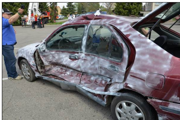
Obr. 14 a 15 Celková energie před střetem 108 kJ, Celková deformační energie: 43 kJ EES vozidla Honda = 26 km/h
