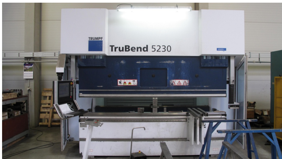
Obr. 1 Hydraulický ohraňovací lis TruBend 5230 (TRUMPF) s lisovací silou 2 300 kN; zdroj vlastní
