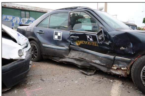
Obr. 18 a 19 Celková energie před střetem 88 kJ, Celková deformační energie: 34 kJ. Pokud uvažujeme EES vozidla Mercedes Benz = 15 km/h vpravo, pak vlevo EES vozidla Škoda Felicia kombi = 24 km/h
