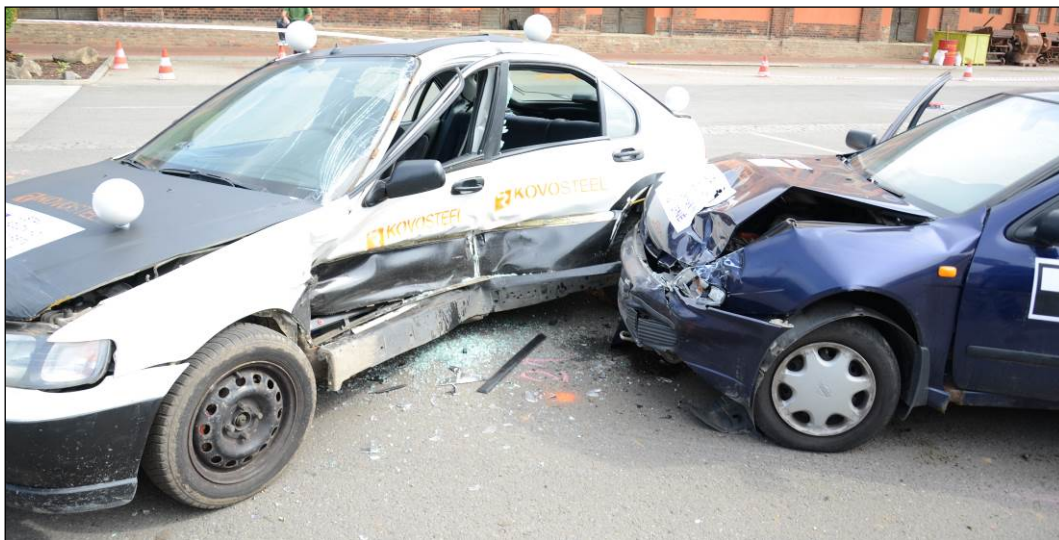
Obr. 11 Celková energie před střetem 122 kJ, Celková deformační energie: 59 kJ. Pokud uvažujeme EES vozidla Honda = 25 km/h vlevo, pak vpravo EES vozidla Nissan = 28 km/h
