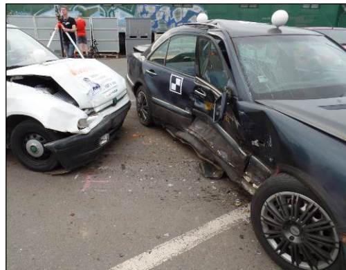
Obr. 18 a 19 Celková energie před střetem 88 kJ, Celková deformační energie: 34 kJ. Pokud uvažujeme EES vozidla Mercedes Benz = 15 km/h vpravo, pak vlevo EES vozidla Škoda Felicia kombi = 24 km/h
