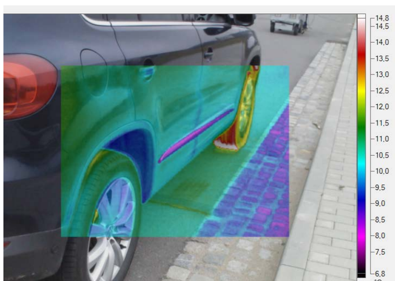
Obr. 5 Tepelný snímek vozidla v konečné poloze, bezprostředně po zabrzdění
