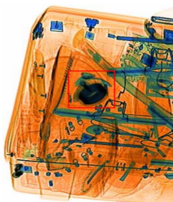
Obr. 17 Ruční granát, jehož přesný reálný tvar není patrný z RTG snímku.
