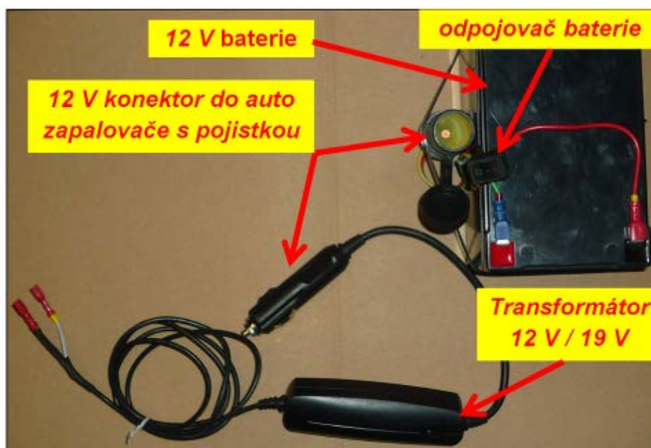
Obr. 3 Univerzální podsystém napájení. [4]
