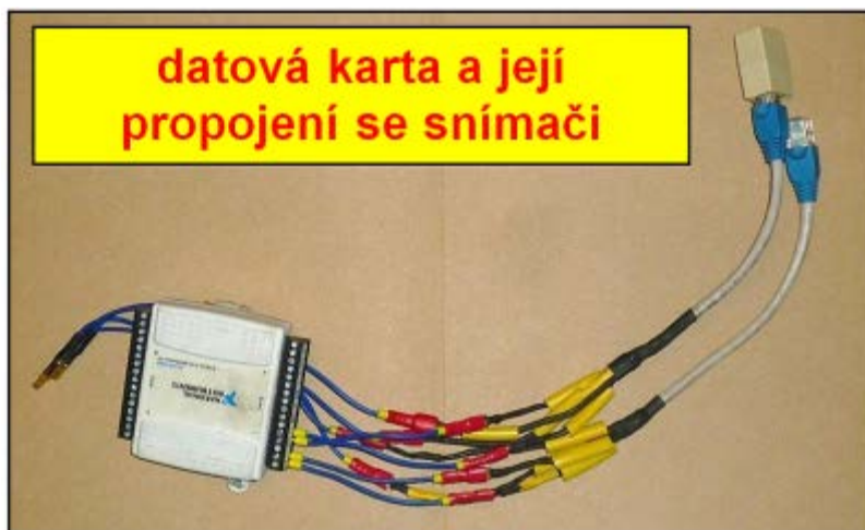
Obr. 5 Datová karta a její propojení se snímači. [4]
