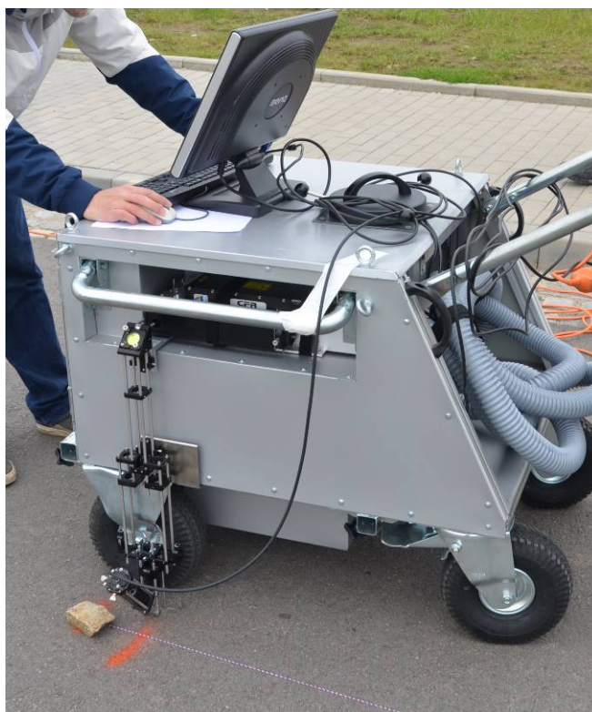
Obr. 1 Zařízení rLIBS při detekci opticky nezřetelné stopy vozidla (archiv autora)
